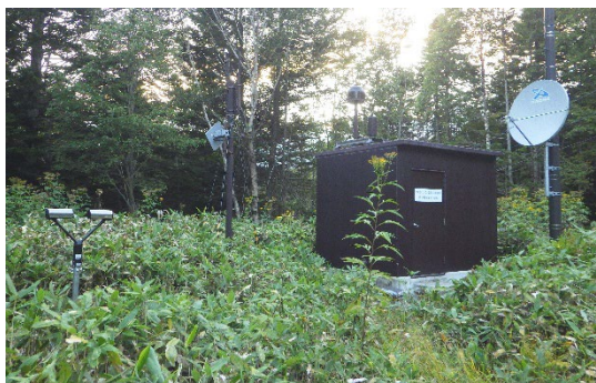
図1． Parsivel ディストロメーターの設置状況。
