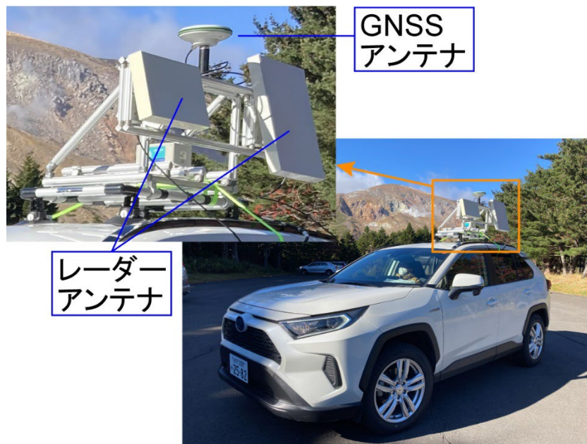
補足第 1 図. 次世代火山研究事業で開発している可搬型レーダー干渉計(SCOPE)の車載方式
