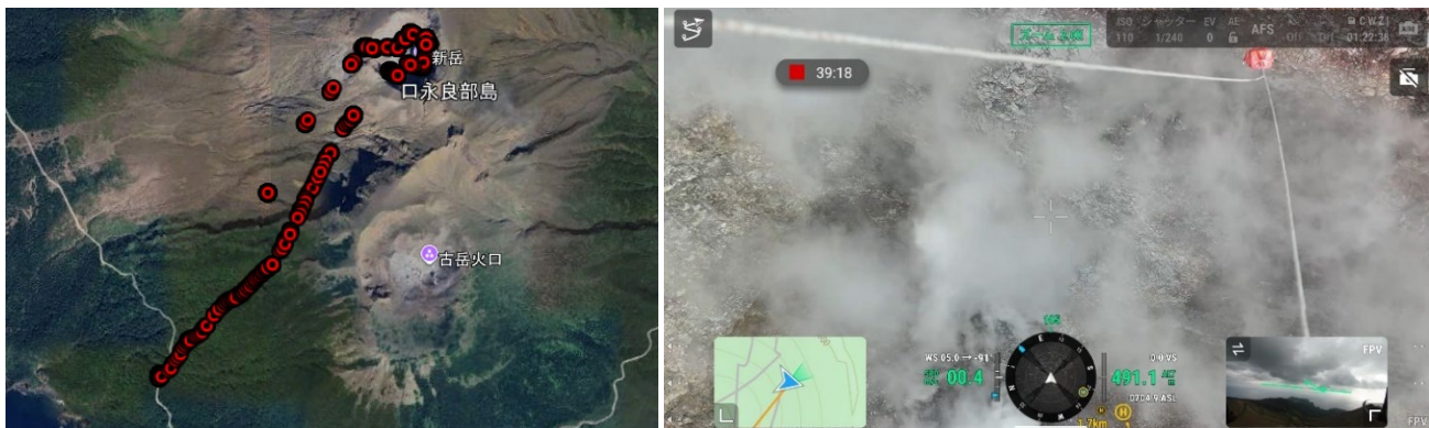
図4：（左）MGF2のフライトルート（一部経路が抜けているのは、MultiGASに取り付けたGPSがうまく更新できなかったため）。（右）MultiGAS装置（右上のロープの先端にある赤いネットに入った発泡スチロールボックス）を新岳の火口底から立ち上がる噴煙に下ろしている様子。
