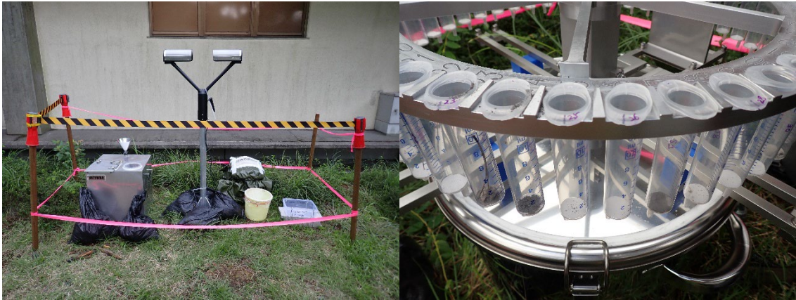
高千穂河原ビジターセンター（KRTC 観測点）に設置された Parsivel および SATSUMA の全景および SATSUMA のシリンダー内に採取された火山灰の様子。
