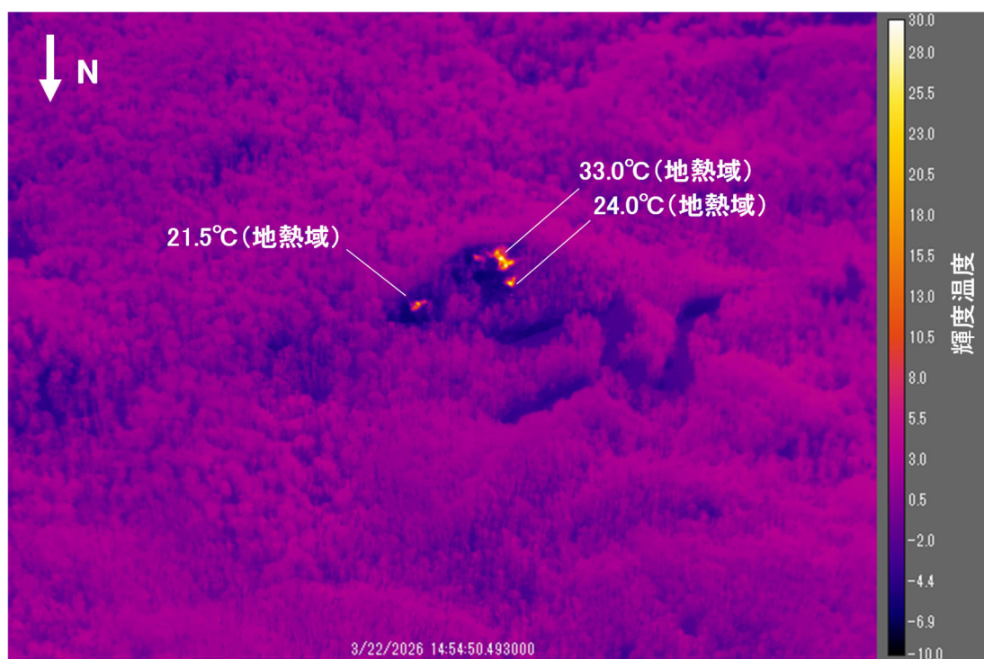
図9. 八幡平(よんご沼南付近)の輝度温度画像(空間分解能約2.0m、北上空海拔1910m、対地高度900m、斜め31°からの観測生画像。2026/3/22 14:54。最高輝度温度33.0°C。
