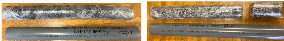
図 10 整形前のボーリングコア試料の梱包状況。
