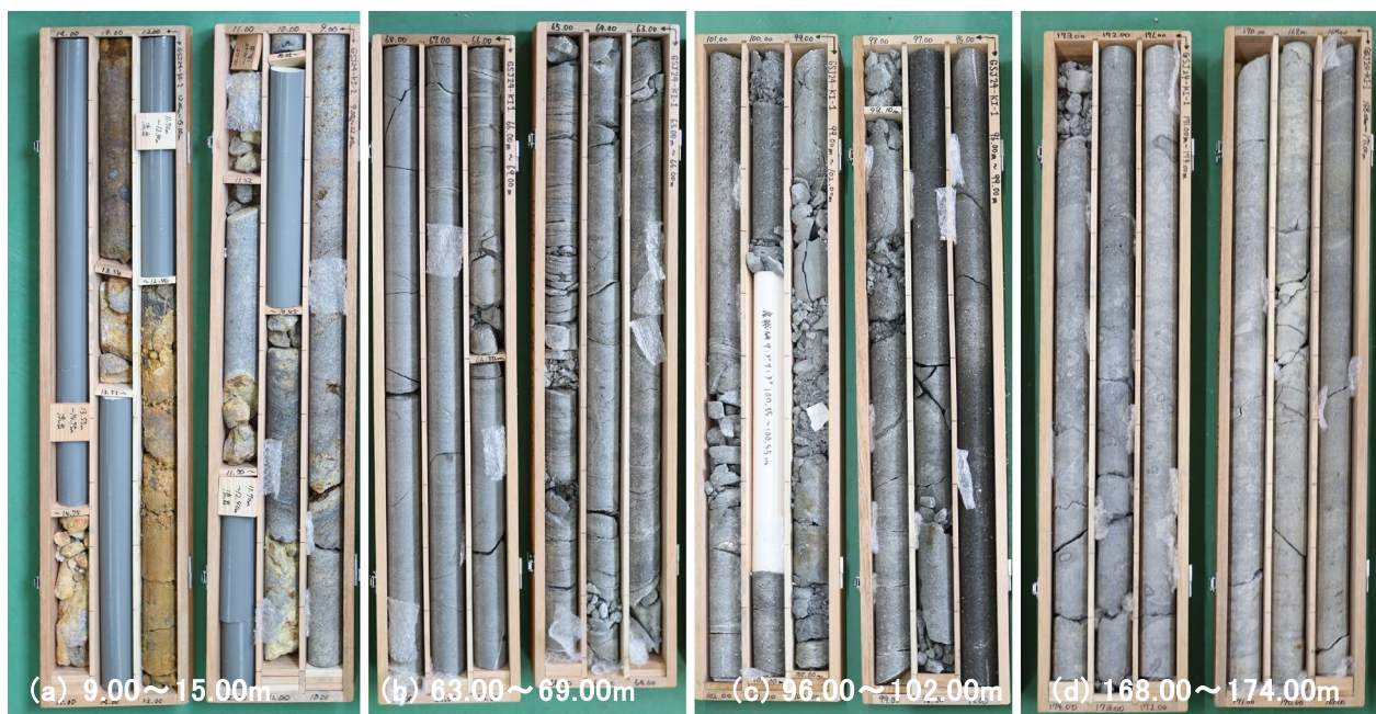
図5 ボーリングコア写真。(a) 深度 9.00～15.00m。灰色安山岩火山岩塊及び黄褐色の粘土質基質に安山岩礫が混じる層。塩ビ管はコア流出(未回収)部。(b) 深度 63.00～69.00m。灰色の塊状安山岩溶岩。深度 65.0～66.5mでは板状節理が発達する。(c) 深度 96.00～102.00m。99.05～100.1m、100.3～100.35mの明灰色～灰色の変質凝灰岩は、母岩の溶岩に火砕岩脈として貫入している。(d) 深度 168.00～174.00m。砂質基質中に色調の異なる亜角礫～亜円礫を含む火山礫凝灰岩、火山礫岩、凝灰角礫岩。
